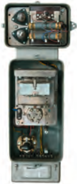
Rheo-Differentialregler: Solche Regler für Klima- anlagen wurden ab ca. 1940 über mehr als 20 Jahre etwa baugleich fabriziert.
